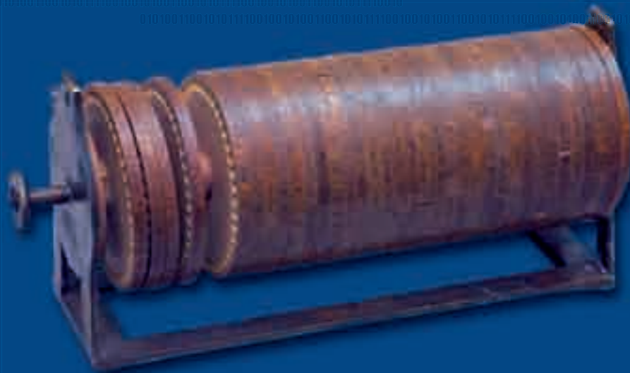
▲ Il cifrario Jefferson, in una raro esemplare d'epoca. Come riferimento alla lettura veniva utilizzato il foro presente sulla parte superiore della staffa di sinistra.
